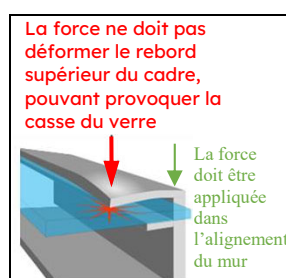
Figure 1a : Position de la Force de serrage de la bride
