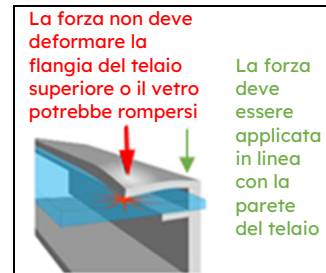
Fig. 1a: posizioni dei morsetti di serraggio
